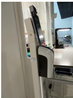
サーモカメラ本体
